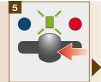
Palanca de selección en posición □. El indicador parpadea una vez cada 2 seg. ➤ la máquina está en modo de descalcificación.
