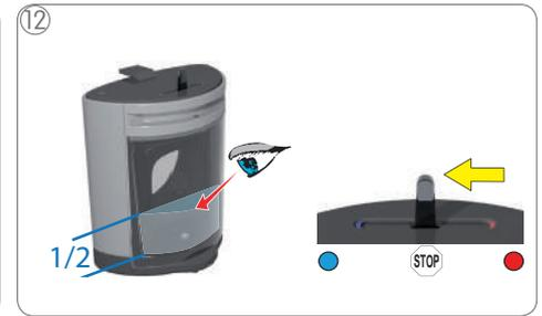
12 Revisar visualmente cuando el depósito de agua se encuentre a la mitad. Colocar la palanca de selección en la posición "ALTO".
