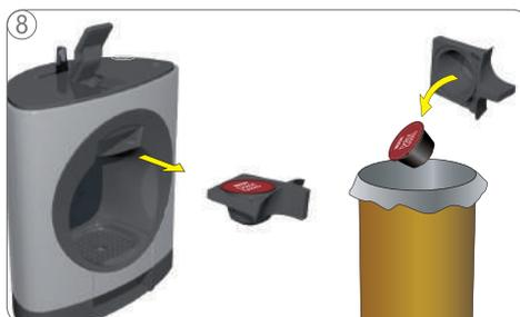
Tirar del soporte de la cápsula y retirar la cápsula usada en el depósito de cápsulas.
